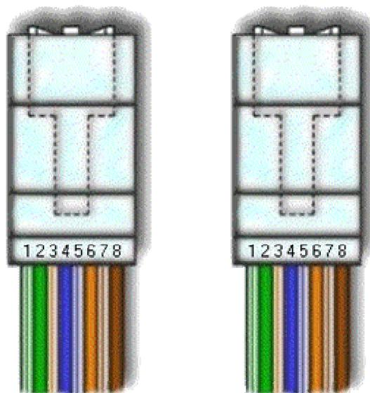
**Schema del cavo di rete UTP RJ45 CAT5 incrociato secondo lo standard EIA/TIA T568B**
